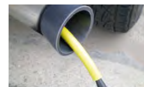
De detector kan eveneens lekken opsporen in het uitlaatsysteem
