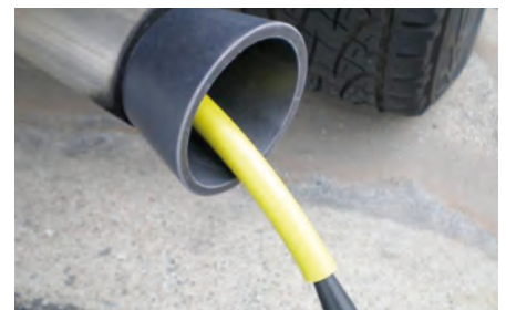
De lekdetector kan ook lekken in uitlaatsystemen opsporen
